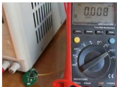
图6 蓝牙MEMS振动传感器实测静态电流
