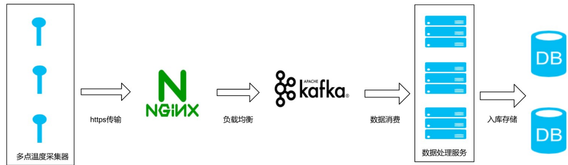
图 3 数据采集处理实现原理图
